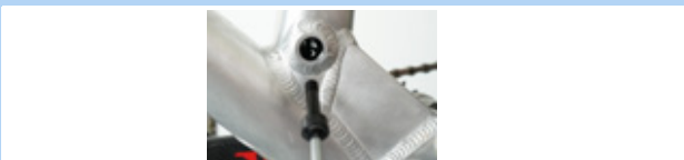
Illustration 180 : Desserrez l'axe Postpin
