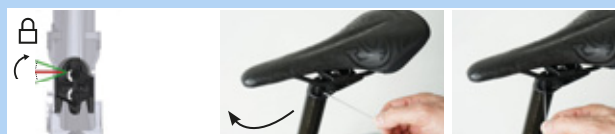
Illustration 214 : Fermer le réglage de la hauteur
