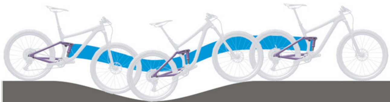
Illustration 19 : Comportement optimal de l'amortisseur arrière en terrain vallonné
