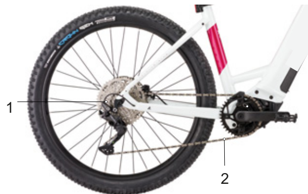
Illustration 33 : Schéma de l'entraînement à chaîne avec dérailleur
