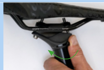
Illustration 233 : Fermer le réglage de la hauteur
