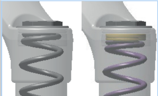
Illustration 107 : Serrer et desserrer l'anneau de réglage de la prétension
