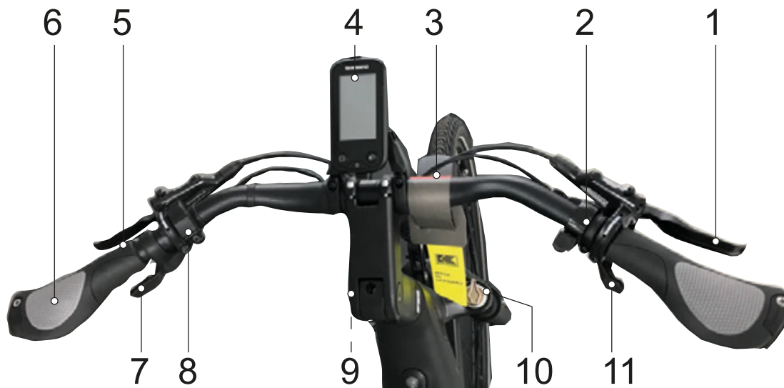
Illustration 38 : Vue détaillée d'un guidon avec ordinateur de bord SHIMANO SC-E5003, exemple
