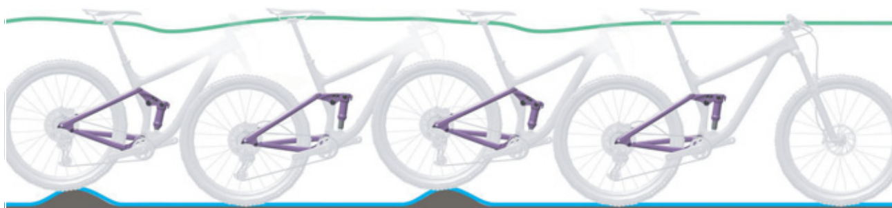
Illustration 15 : Comportement optimal de l'amortisseur arrière
