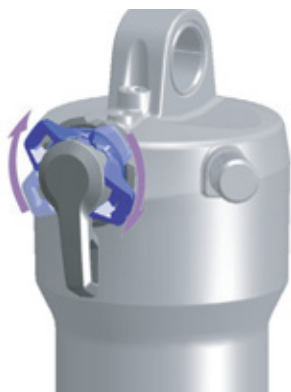
Illustration 121 : Régler le dispositif de réglage de la compression sur un niveau plus dur
