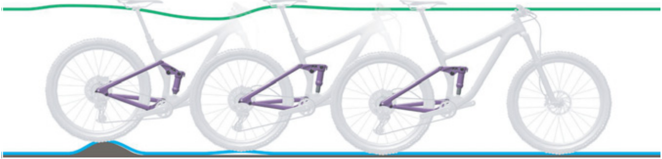
Illustration 255 : Détente trop rapide de l'amortisseur arrière
