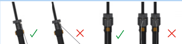
Illustration 204 : Câble Bowden correct et incorrect
