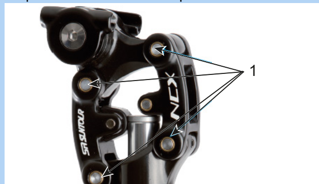
Illustration 176 : Points de lubrification de la tige de selle suspendue SR Suntour
