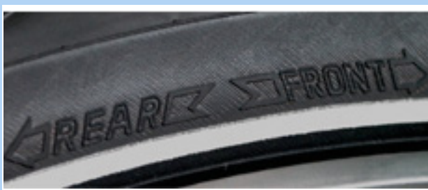
Illustration 50 : Flèche directionnelle sur les pneus VTT
