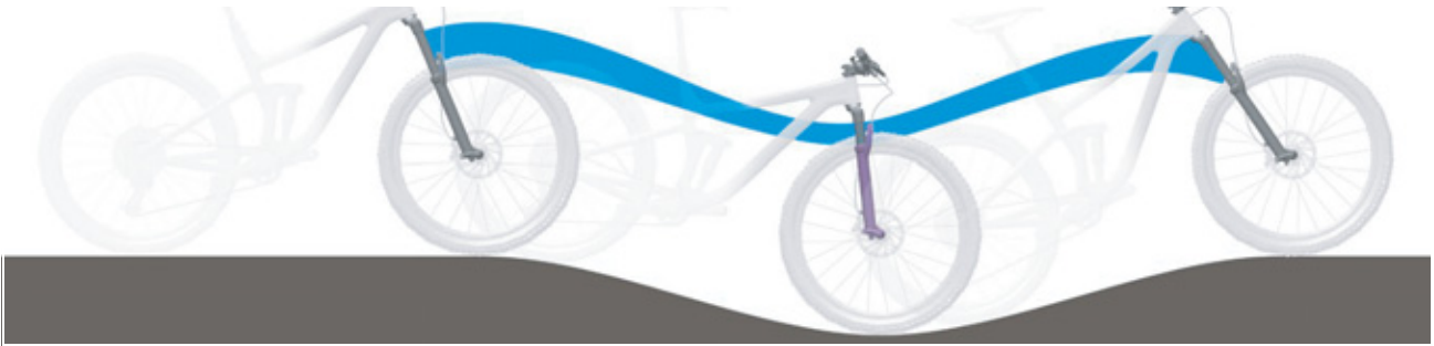
Illustration 251 : Suspension trop souple de la fourche suspendue dans les côtes
